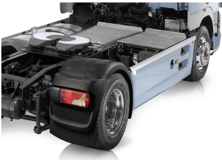
Die DAF-Baureihen CF und XF105 erhalten neue Schmutzfänger zur Verringerung der Schadenanfälligkeit.
