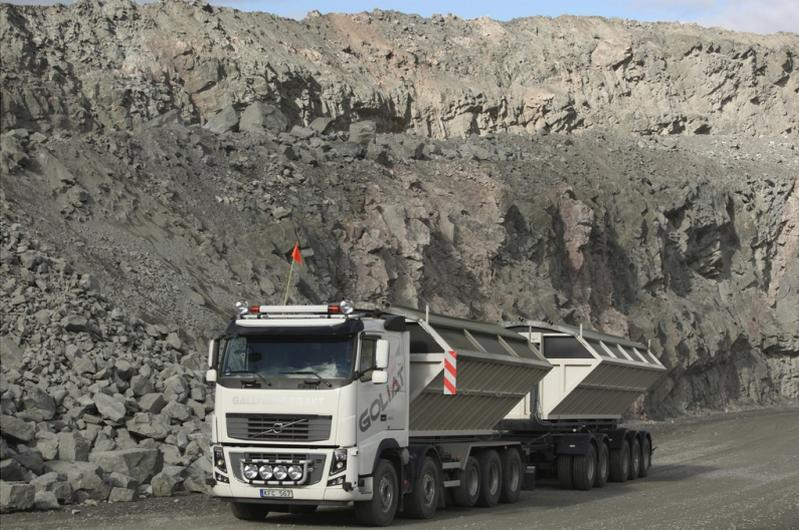
Der Volvo FH16 Goliat und der Anhänger sind mit Luftfederung und verstärkten Achsen ausgerüstet, Der Lastzug besitzt insgesamt 36 Reifen.
