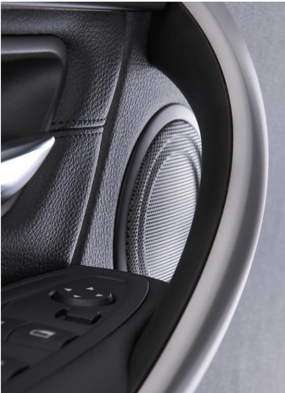
Die Türverkleidungen des neuen BMW 3er fertigt Johnson Controls in Hybridbauweise aus Naturfasern und Kunststoff. Sie sind 20 Prozent leichter als herkömmliche Komponenten.
