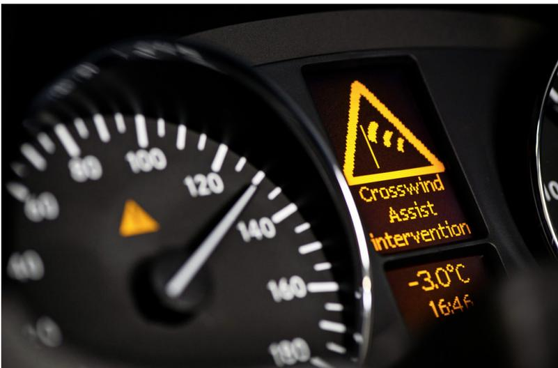
Mercedes-Benz Sprinter: Seitenwind-Assistent.
