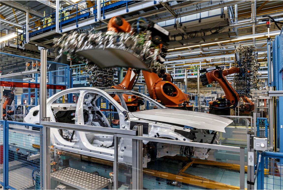
Produktionsanlauf der C-Klasse in Bremen: Das Dach wird erst sehr spät im Produktionsablauf auf die Karosserie geklebt.
