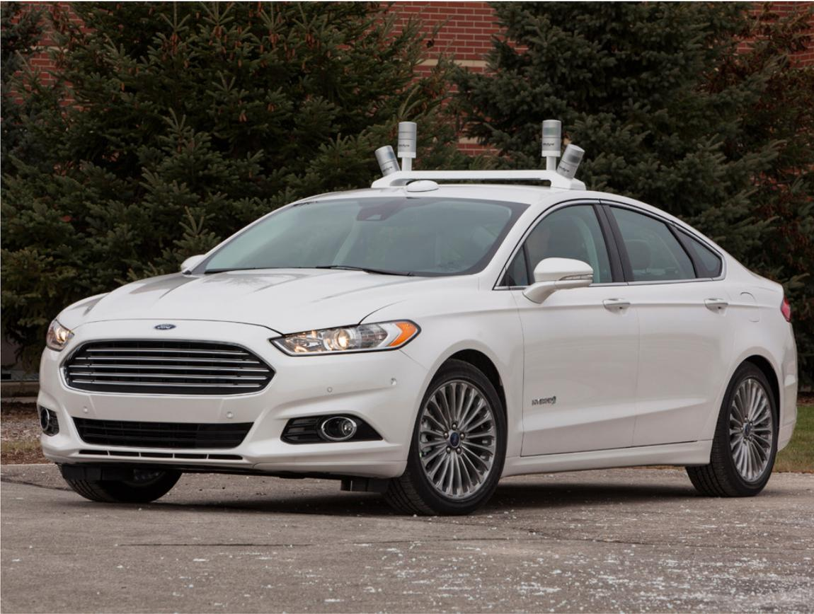
Ford nutzt einen Fusion als Versuchsträger für automatisiertes Fahren.
