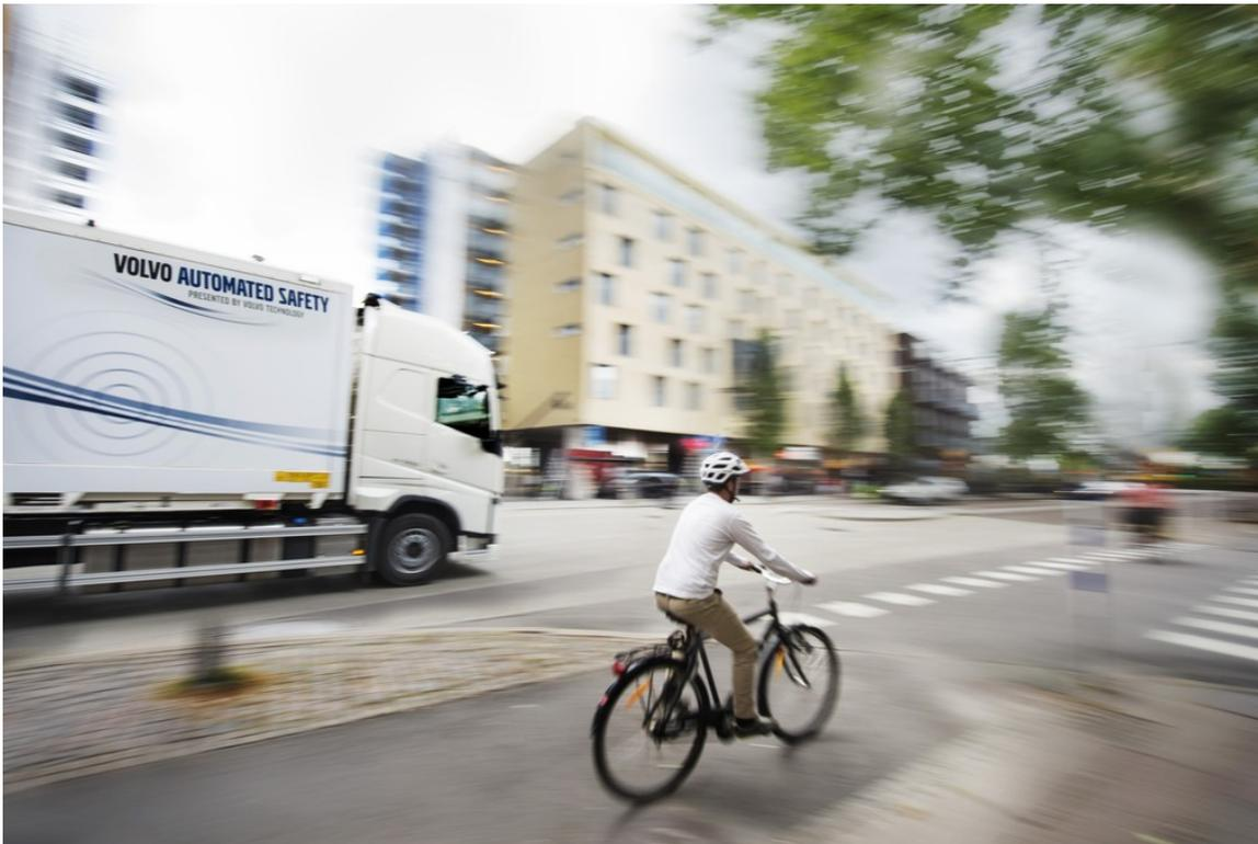
Volvo hat ein System entwickelt, das im Lkw alle 25 Millisekunden einen 360- Grad-Scan der Umgebung macht: Bei Bedarf schlägt das System Maßnahmen zur Unfallvermeidung vor, zum Beispiel bei drohenden Kollisionen mit Fahrradfahrern.
