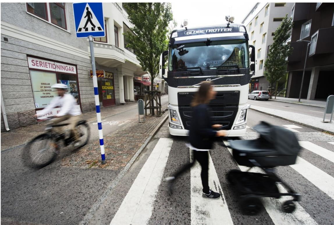
Volvo hat ein System entwickelt, das im Lkw alle 25 Millisekunden einen 360- Grad-Scan
