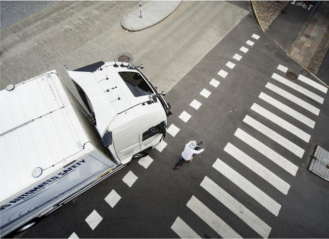
Volvo hat ein System entwickelt, das im Lkw alle 25 Millisekunden einen 360- Grad-Scan der Umgebung macht: Wenn der Fahrer nicht auf die vom System vorgeschlagenen Handlungen reagiert, kann das Lenk- oder Bremssystem selbstständig aktiviert werden.
