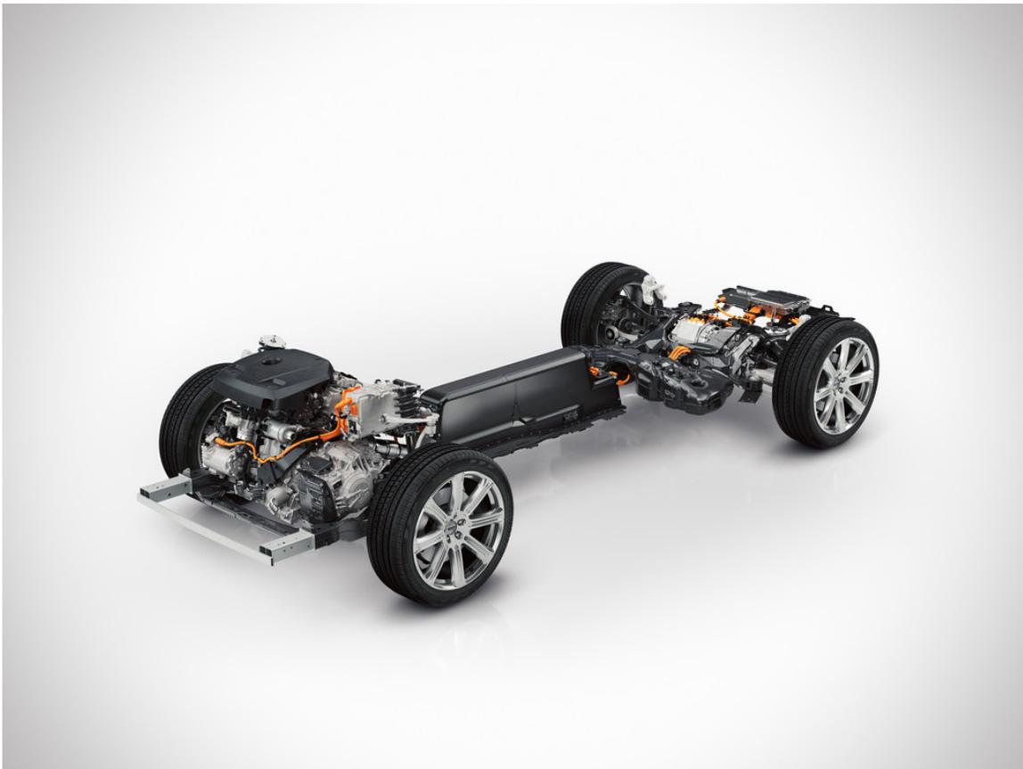
Volvo XC90 T8 Twin Engine: Verbrennungsmotor vorn, Batterie im Tunnel, Elektromotor zwischen den Hinterrädern sowie zwischen Verbrenner und Getriebe ein weiterer Motor-Generator.
