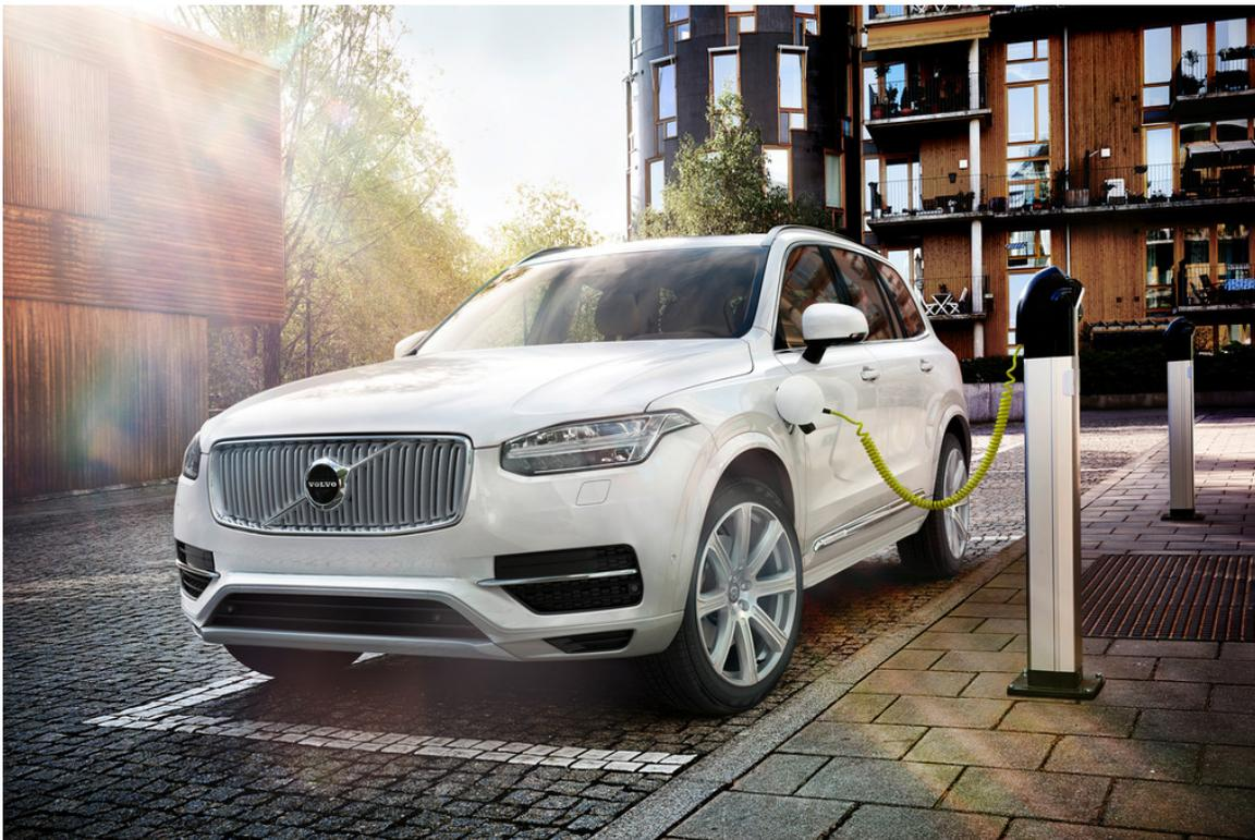
Volvo XC90 T8 Twin Engine: Bei 16 Ampere ist die Batterie in 2,5 Stunden wieder voll und reicht dann für mehr als 40 Kilometer rein elektrisches Fahren.
