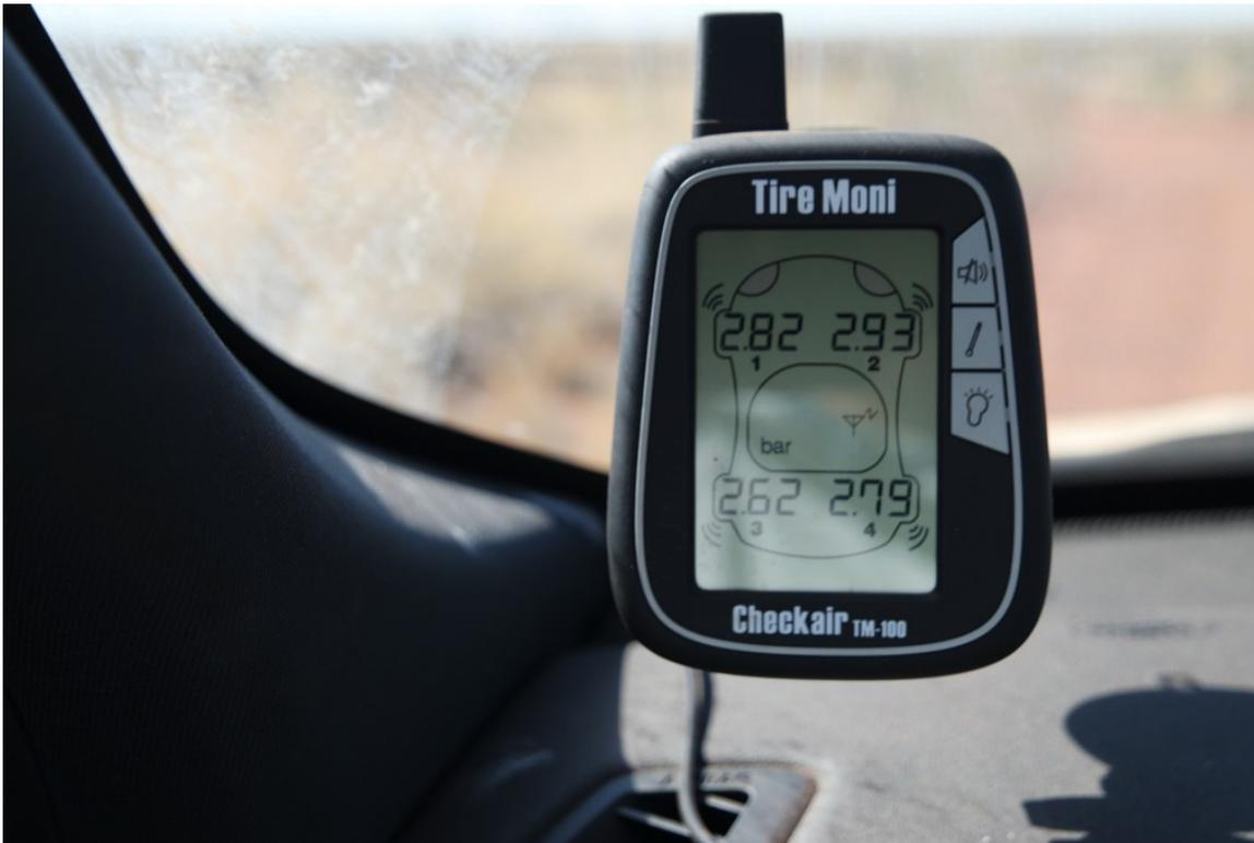
Land Rover Experience Australia 2015: Noch ist der Reifendruck rundum normal. Aber vier Mal während der Tour meldete das Gerät einen Platten oder langsam entweichende Luft.
