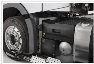
Volvo Trucks mit neuem Batteriesystem für den FH und FM.
