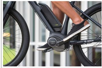
Bosch-Antrieb eines E-Bikes.
