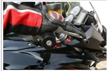
Bei ausgestreckter Hand zum Bremshebel sollten Unterarm, Handfläche und Finger des Fahrers eine Linie bilden.
