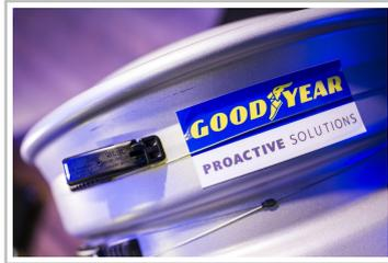
Goodyear nutzt sein Reifendruckkontrollsystem auch, um auf drohende Pannen hinzuweisen; Alle 16 Sekunden misst die Technik den Luftdruck und die Temperatur, so dass die Disponenten in der Spedition vorab gewarnt werden können.
