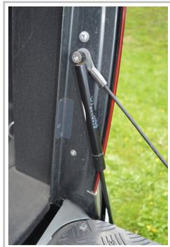
Easy-Down-Gasdruckdämpfer von Seikel für die Heckklappe des VW Amarok.
