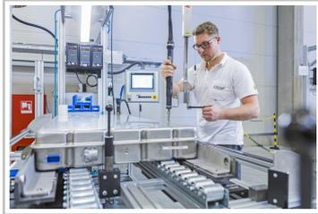
Produktion von Serien-Batteriesystemen bei Akasol.
