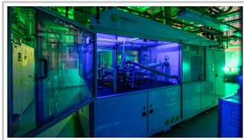
Hochleistungsprüfstand zum dauerhaften Test von Antriebsleistungen bis zu 150 Kilowatt der TU Chemnitz.
