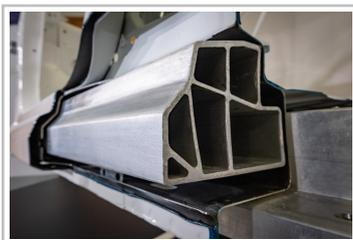
Querschnitt des Aluminiumprofils im Schweller des Volkswagen ID 3.
