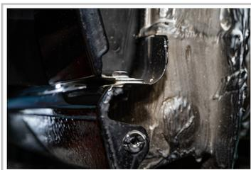
Konservierte Schweller- und Kotflügel-Falzkanten im Radhaus des VW Golf 8.
