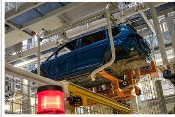
VW-Tiguan auf dem Weg zur Kaltwachsanlage im VW-Werk Wolfsburg.
