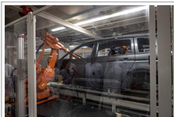
VW-Tiguan bei der Kaltwachs-Hohlraumversiegelung im VW-Werk Wolfsburg.
