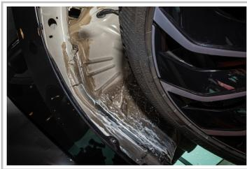
Falzkanten mit PVC-Kitt sowie Hohlraumwachs unter der Radhausverkleidung des VW Golf 8.
