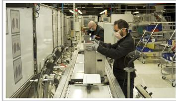
Jedes Beatmungsgerät hat mehr als 80 elektronische und mechanische Komponenten und wird einer gründlichen Qualitätskontrolle und einer UV-Licht-Sterilisation unterzogen.
