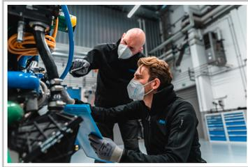
Brennstoffzelle von Ballard im Mahle-Testcenter.
