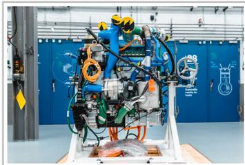
Lkw-Brennstoffzelle von Ballard im Mahle-Testcenter.
