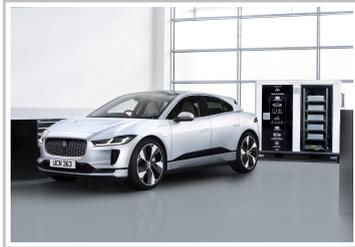
Ältere Batterien aus Prototypen und Vorserienfahrzeugen des Jaguar I-Pace werden in einem mobilen Energiespeicher zur Stromversorgung weiter genutzt.
