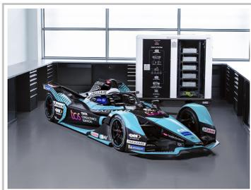
Ältere Batterien aus Prototypen und Vorserienfahrzeugen des Jaguar I-Pace werden in einem mobilen Energiespeicher zur Stromversorgung weiter genutzt. Jaguar selbst hat sie bei den Tests zur Formel-E-Weltmeisterschaft eingesetzt.
