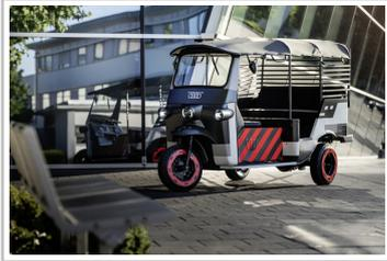
Von Auszubildenden aus Neckarsulm gebaut: Elektro-Rikscha mit Second-Life-Batterie der e-Tron-Testflotte von Audi.
