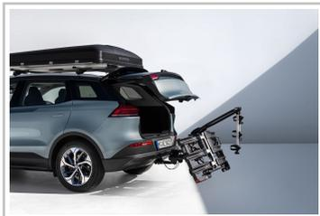
Nachrüstbare abnehmbare Anhängerkupplung für den Aiways U5 SUV mit maximal 100 kg.
