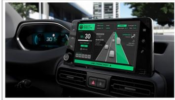
Software von Ai Motive in einem Prototyp für autonomes Fahren.
