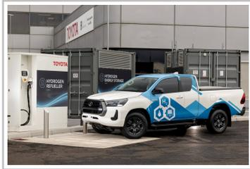
Toyota Hilux mit Brennstoffzellenantrieb.
