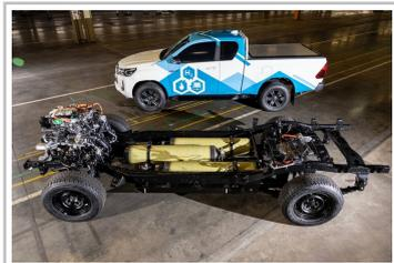
Toyota Hilux mit Brennstoffzellenantrieb.
