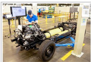
Toyota Hilux mit Brennstoffzellenantrieb.
