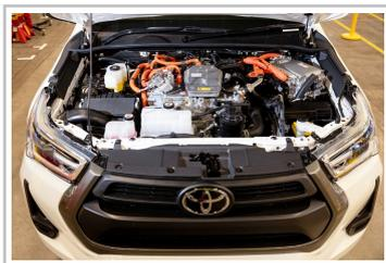
Toyota Hilux mit Brennstoffzellenantrieb.
