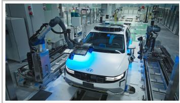
Produktion eines Hyundai Ioniq 5 Robotaxi.
