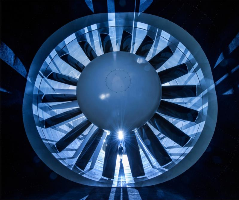
Neun Meter Durchmesser misst die Turbine des neuen Windkanals von Mercedes-Benz.
