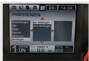
Can-Am Spyder ST: Für den Anhängerbetrieb ist ein spezielles Motormapping hinterlegt.
