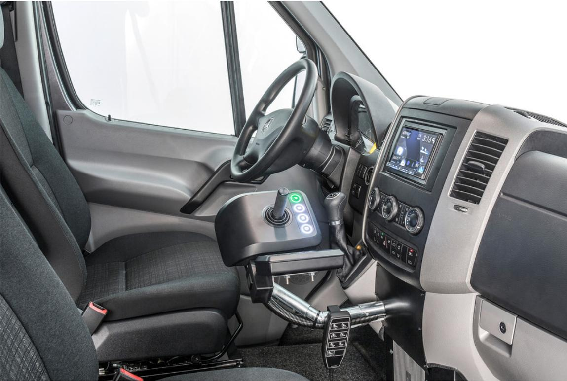
Auf- und Ausbauten von Mercedes-Benz Vans: Fahren mit dem Joystick für Behinderte.
