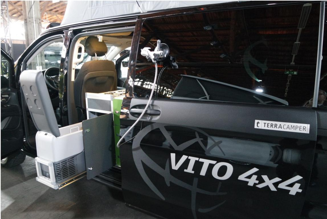
Auf- und Ausbauten von Mercedes-Benz Vans: Terra Camper 4x4 mit demontierbaren Möbeln, Außendusche und Kühlbox von Waeco, die von innen und von außen benutzt werden kann.
