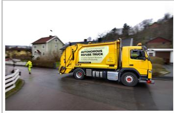
Volvo erprobt einen selbstfahrenden Müllwagen.
