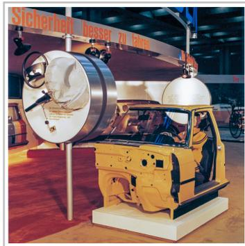
IAA 1975: Mercedes-Benz zeigt den Stand der Airbagforschung. Das Projekt wird unter dem Namen „Luftsack für Fahrer und Beifahrer als mögliche Ergänzung zum Sicherheitsgurt“ vorgestellt.
