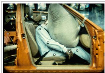
Crashversuch bei Mercedes-Benz mit Beifahrerairbag (1990).
