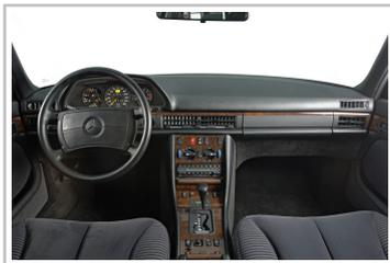
Mercedes-Benz S-Klasse Limousine der Baureihe 126: Die in Lenkrad und Armaturenbrettverkleidung eingeprägte Kennzeichnung „SRS AIRBAG“ verweist darauf, dass dieses Fahrzeug mit Gurtstraffern und Airbags für Fahrer und Beifahrer ausgestattet ist. SRS steht für Supplementary Restraint System – zusätzliches Rückhaltesystem.
