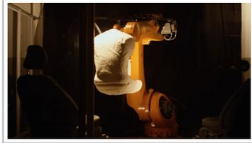
Ford testet die Belastbarkeit von Autositzen mit einem Roboter-Gesäß.
