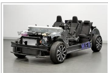
Modularer E-Antriebs-Baukasten (MEB).
