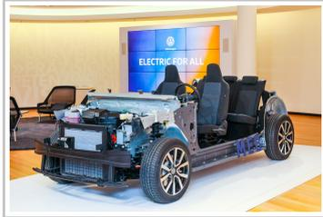
Modularer E-Antriebs-Baukasten (MEB).
