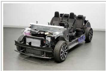
Modularer E-Antriebs-Baukasten (MEB).
