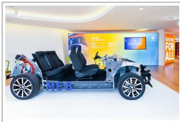
Modularer E-Antriebs-Baukasten (MEB).
