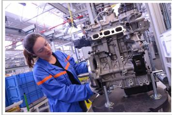
Produktion des Drei-Zylinder-Turbomotors bei PSA.
