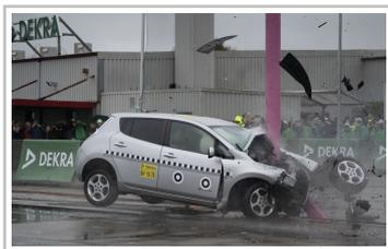
Dekra-Crashtest: Älterer Nissan Leaf beim frontalen Pfahlaufprall mit 85 km/h.
