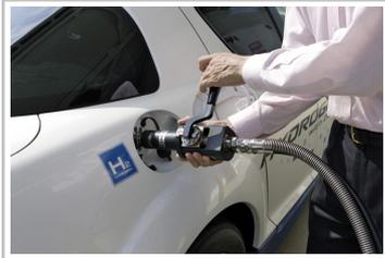
Betankungsvorgang eines Mazda-RX-8-Versuchsfahrzeugs mit Renesis-Hydrogen-Kreiskolbenmotor.
