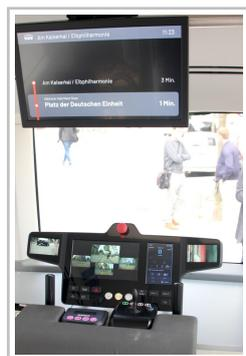
HEAT Shuttle Hamburger Hafencity. Überwachungsstand.
