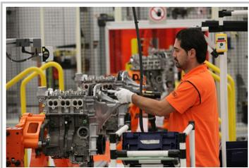
Produktion des 1,0-Liter-Ecoboost-Dreizylinder bei Ford.
