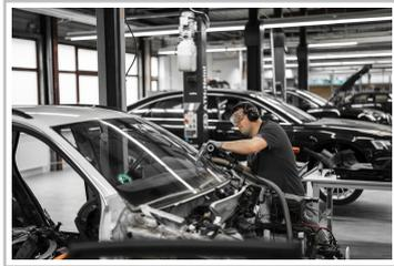
Eine defekte Windschutzscheibe wird bei Audi demontiert, um einen Teil des Glases wiederzuverwerten.
