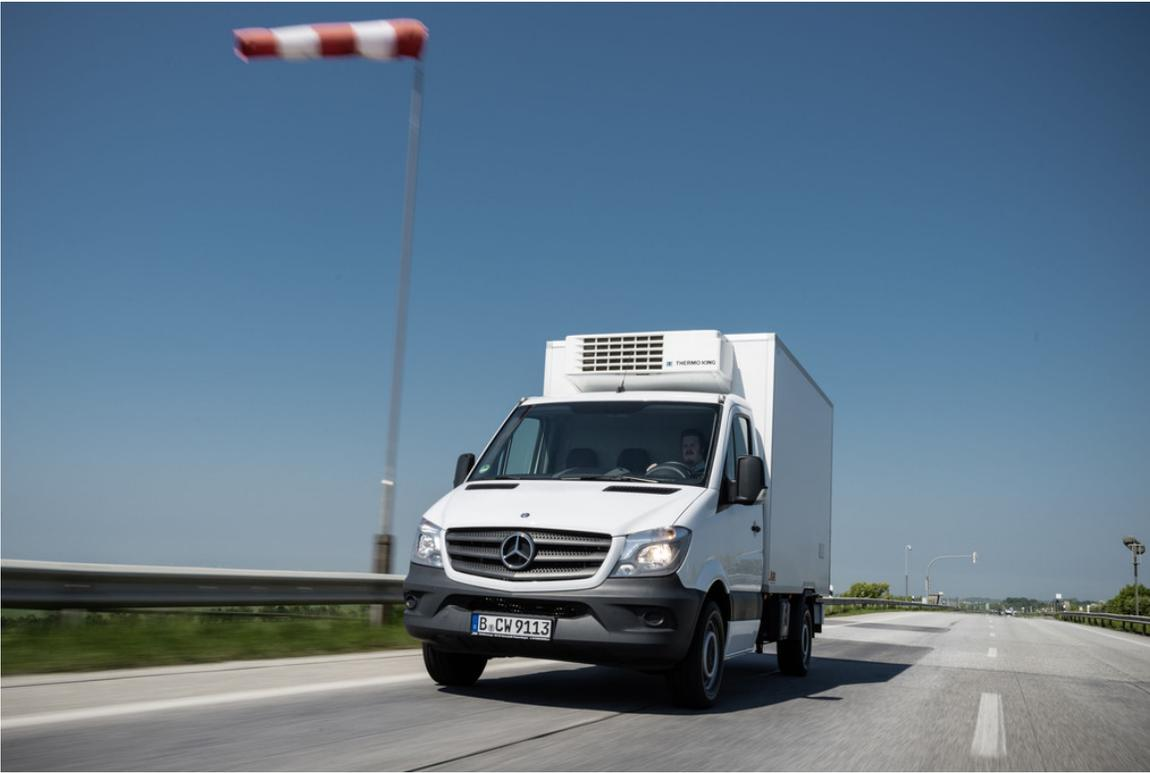
Mercedes-Benz Sprinter mit Seitenwind-Assistent.
