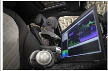
Das Mercedes-Benz Technologie Center (MTC) in Sindelfingen entwickeln für jedes Elektromodell einen individuell abgestimmten E-Sound. Teil der Entwicklung sind Testfahrten mit einem Kunstkopf.
