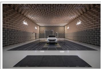
Der Außengeräuschprüfstand im Mercedes-Benz Technologie Center (MTC) in Sindelfingen.
