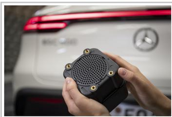
Soundmodul für Elektrofahrzeuge von Mercedes-Benz.
