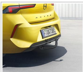
Opel Astra mit abnehmbarer Anhängerkupplung aus dem Originalzubehör.
