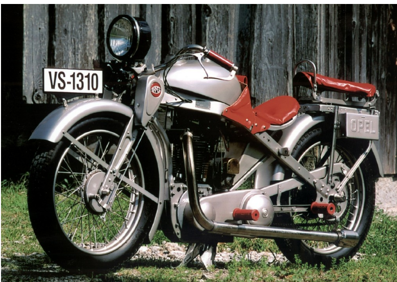
Opel-Zweizylinder-Luxus- Motorrad mit 3 1/2 PS und elektromagnetischer Zündung aus dem Jahr 1905
