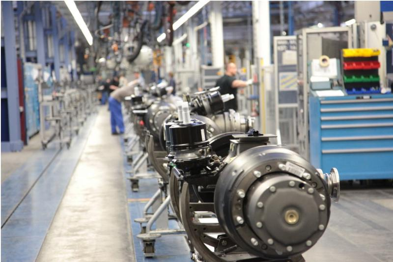
Seit 40 Jahren werden am Standort Gaggenau erfolgreich Außenplanetenachsen gefertigt. Außenplanetenachsen kommen beispielsweise in Baustellenfahrzeugen zum Einsatz, damit Fahrten in schwerem Gelände möglich sind.
