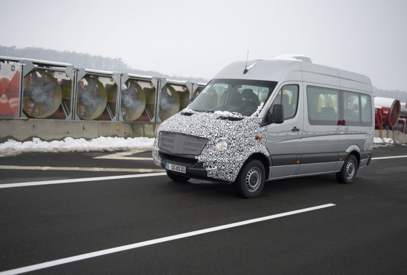
Seitenwind-Assistent von Mercedes-Benz Vans.
