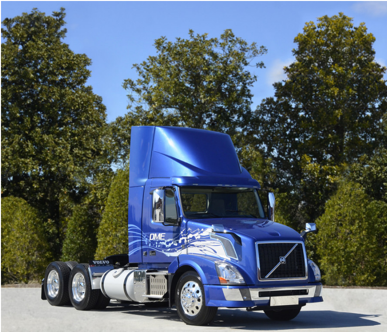
Volvo VNL mit D13-DME-Motor, 313 kW / 425 PS und 1750 Nm.
