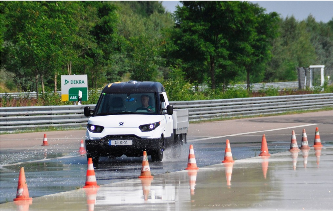
StreetScooter bei der Bremsmessung auf der ABS-Strecke im DEKRA Automobil Test Center in Klettwitz.
