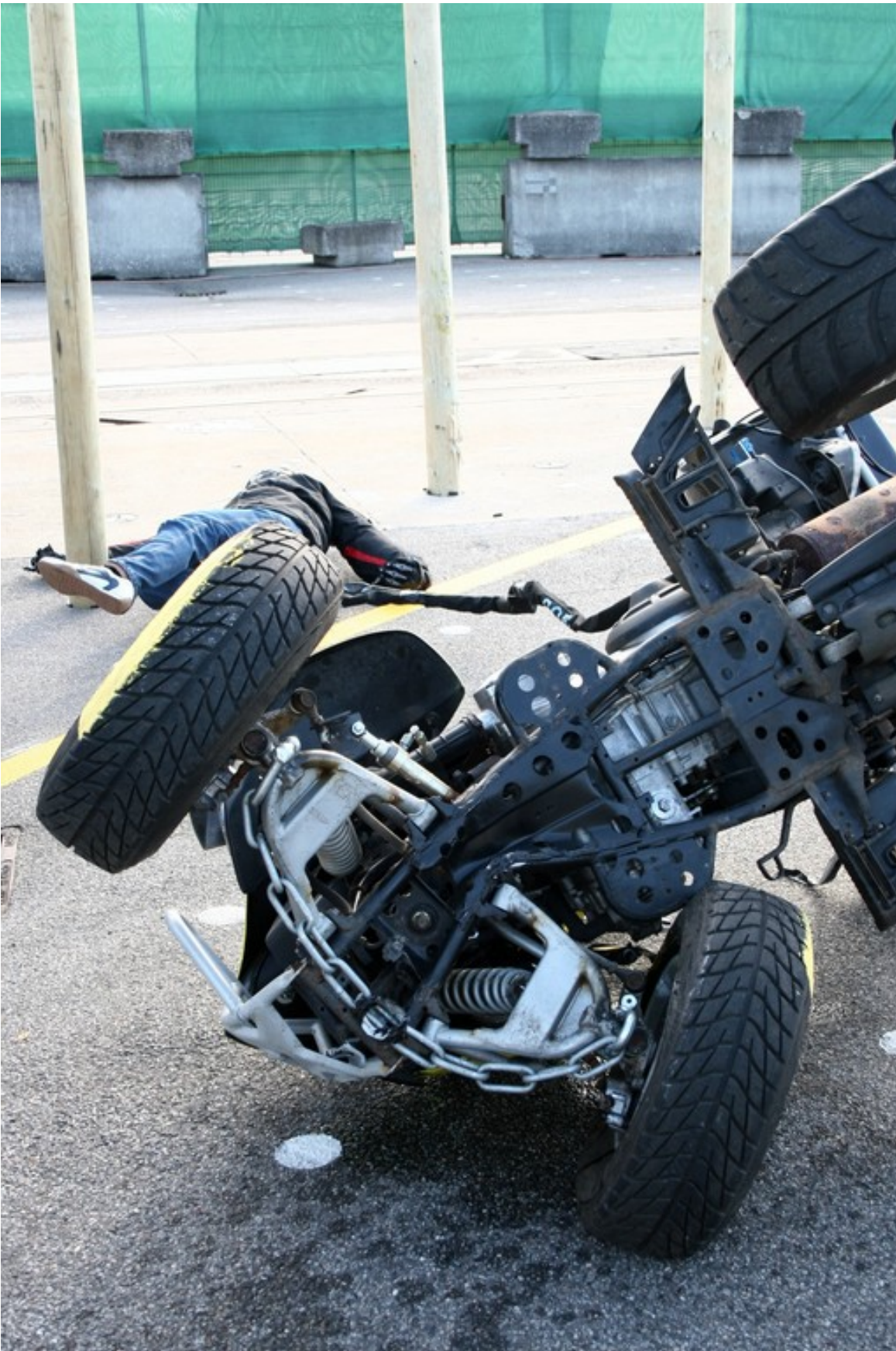
Quad-Crashtest der UDV auf dem Dekra-Gelände in Neumünster.
