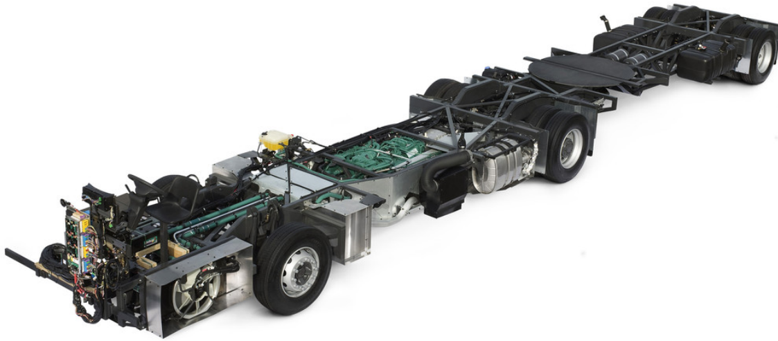
Volvo-Gelenkbus-Fahrgestell B340M für das BRT-System in San Salvador.
