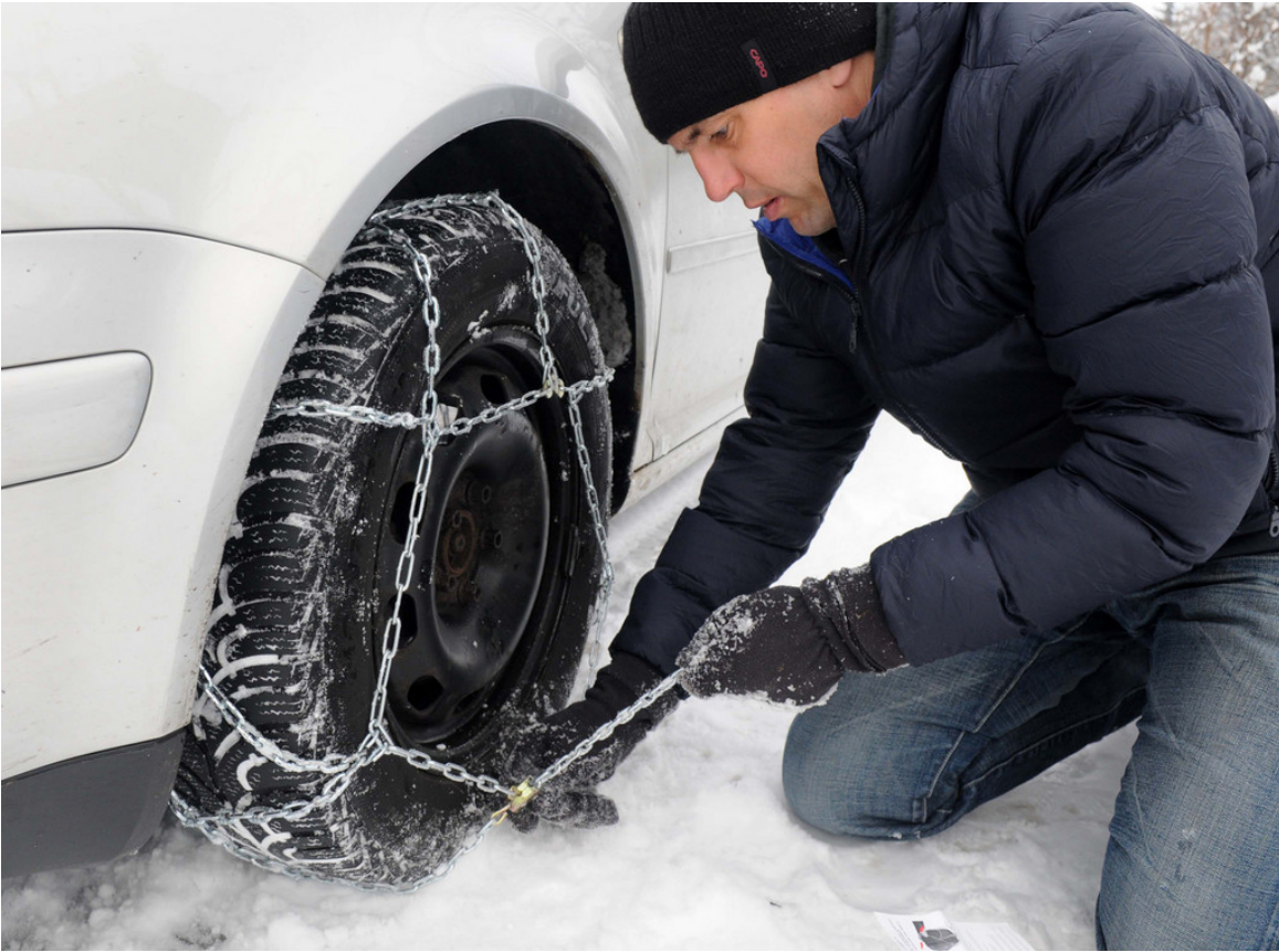
Aufziehen von Schneeketten.
