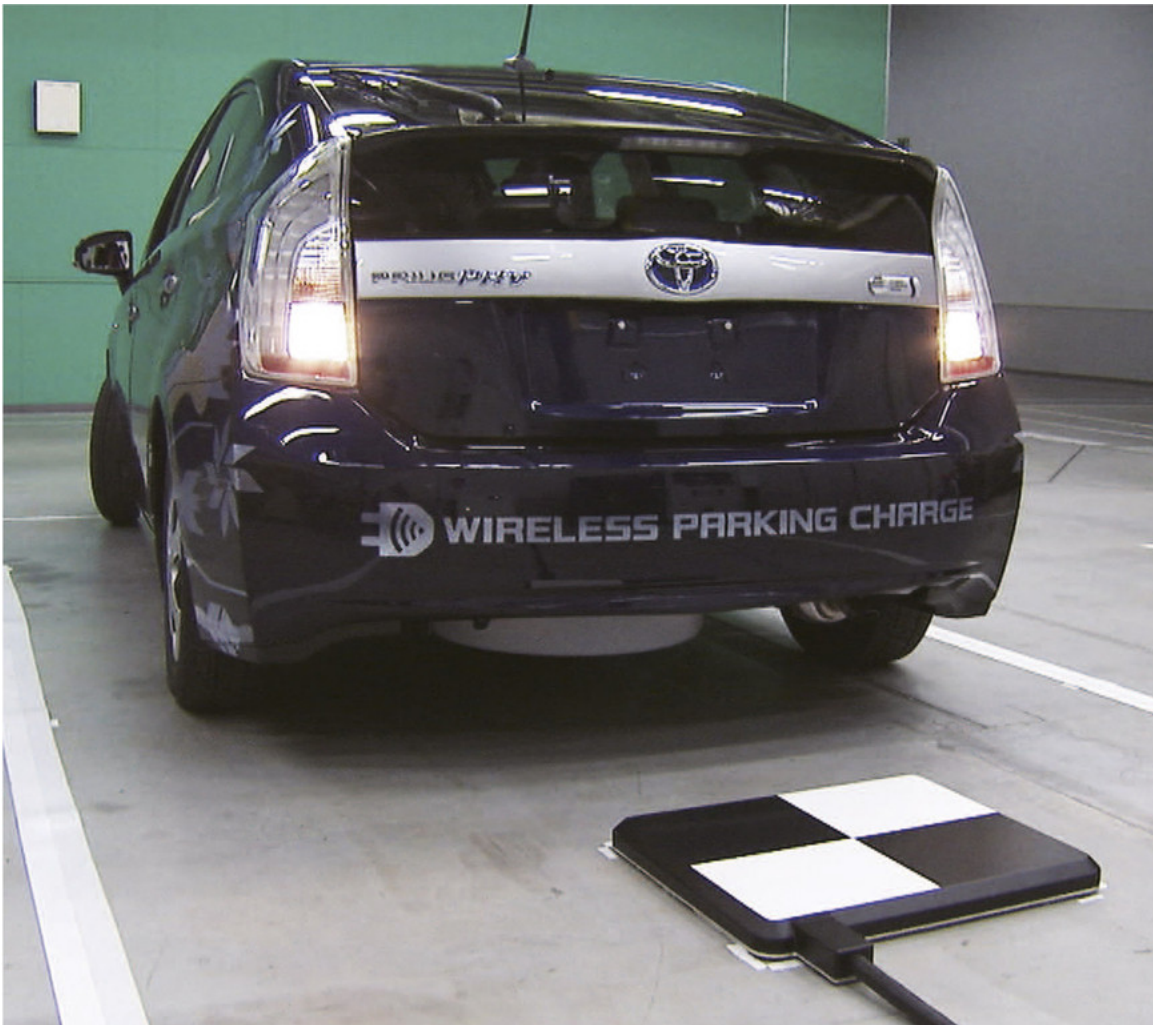
Toyota testet ein kabelloses Ladesystem für Plug-in-Hybrid- und Elektrofahrzeuge.
